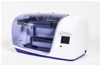
Le BDI I est un instrument qui réalise les différentes étapes d'incubation et de lavage des bandelettes immunodot d'Alphadia, du dépôt de l'échantillon au développement final de la couleur. La capacité maximale est de 24 bandelettes qui sont incubées simultanément. Chaque bandelette est associée à une cartouche contenant les différents réactifs permettant de réaliser le test. Le BDI I dispose d'un lecteur de code-barres qui contrôle la bonne association entre une bandelette et sa cartouche.
